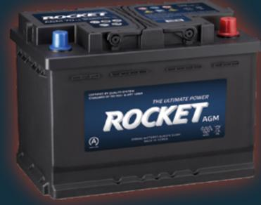
Diese Technologie mit erhöhter Lebensdauer und verbesserter Schnellladefähigkeit verwendet Absorbent Glass Mat (AGM) Separatoren, die die Säure besser binden und damit das vorhandene Zellvolumen effektiver nutzen als Standardbatterien und daher besonders für Fahrzeuge mit Start-Stopp-Technik geeignet sind.
